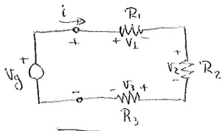
malla:  $V_g - V_1 - V_2 - V_3 = 0$
