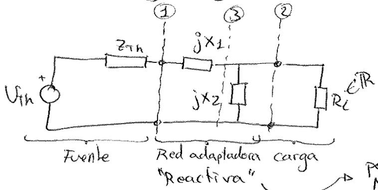
por ser reactiva NO se disipa potencia en ① ② ③ hay misma potencia
