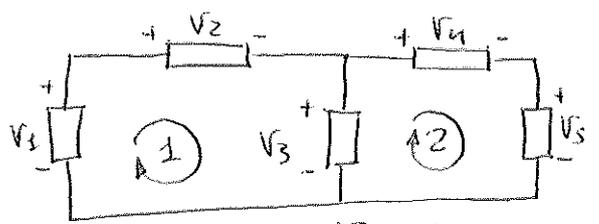
1:  $V_1 - V_2 - V_3 = 0$
