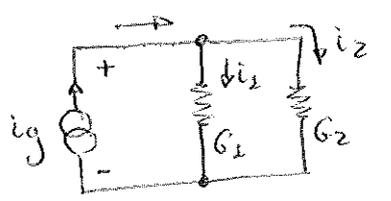
$$i_g = i_1 + i_2 = G_1 V + G_2 V$$
