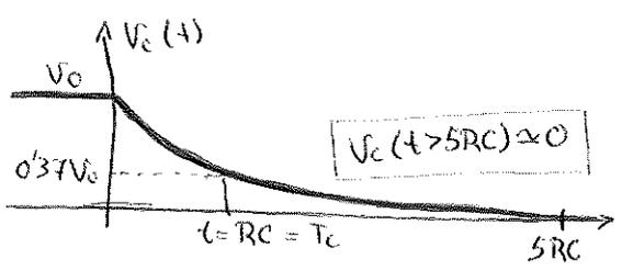
La respuesta del circuito depende de: cte de tiempo y C.I ( $V(t=0) = V_0$ )
