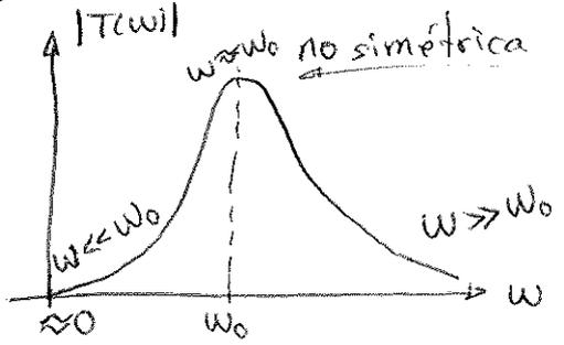
$$\omega_0 = \sqrt{\omega_{c1} \cdot \omega_{c2}} \text{ (ver ancho de banda)}$$
