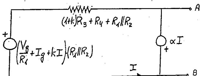
A partir de este circuito, simplificado al máximo, calcularemos  $V_{th}$  y  $R_{th}$ .
