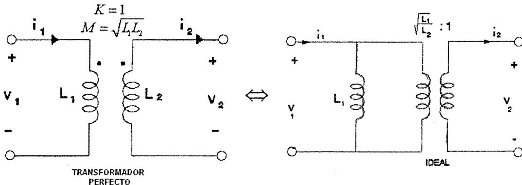
Es decir, el transformador perfecto se puede modelar como un transformador ideal con  $a = \sqrt{L_1 / L_2}$  en "paralelo" con la bobina del primario  $L_1$ .
