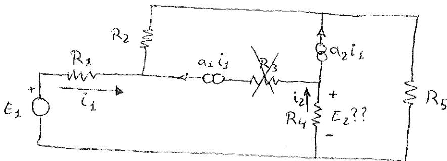
El valor de  $R_3$  no influye en la corriente que circula por su rama, porque dicha corriente viene fijada por el generador, no por la resistencia. Por esto, podemos sustituir  $R_3$  por una resistencia nula (cortocircuito).
