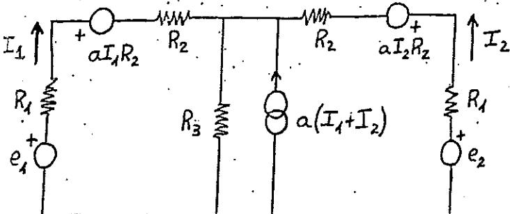
Transformamos el generador central de corriente a tensión. También transformamos en resistencias los generadores de tensión controlados por la corriente que los atraviesa.
