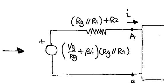
**IMPORTANTE!**: este todavía no es el circuito equivalente de Thevenin, pq el generador de tensión es dependiente, y en un circuito equivalente de Thevenin el generador debe ser independiente.
