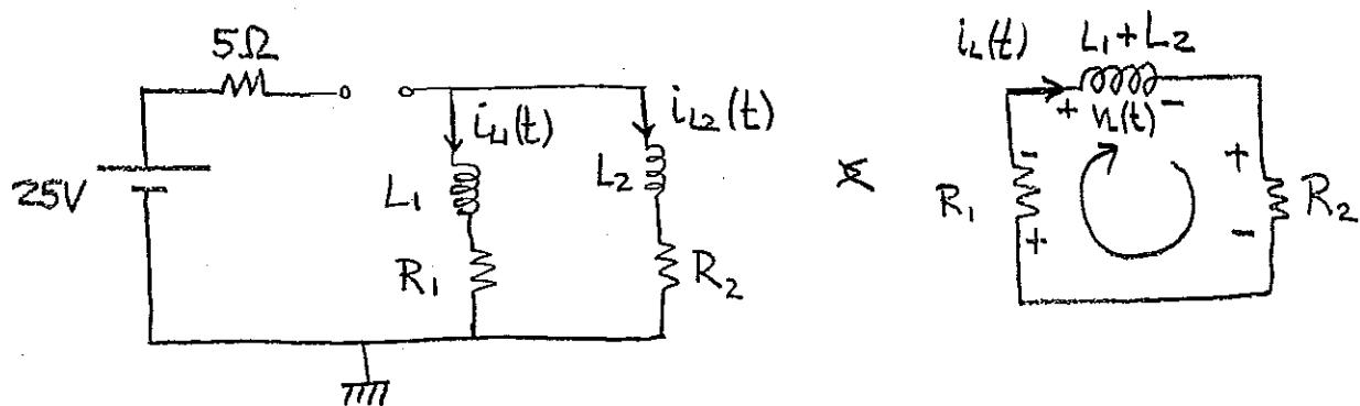
En este intervalo las 2 bobinas estarán en serie, y circulará por ellas una corriente  $i_L(t) = i_{L2}(t) = -i_{L1}(t)$  (Ver dibujo de arriba).
