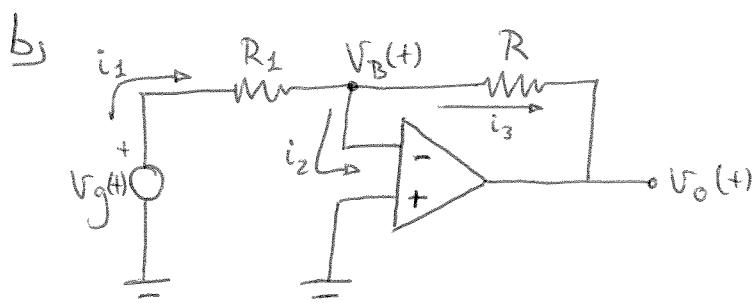
Función de un circuito con amplificador op.
