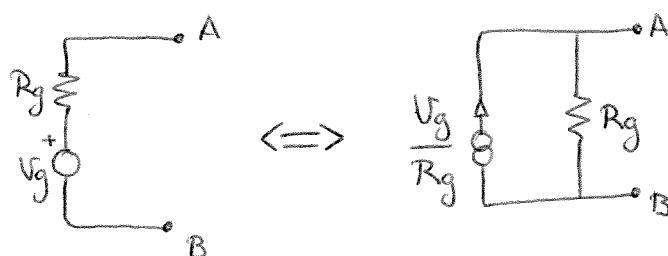
Recíprocamente, un generador de corriente real (generador de corriente ideal de magnitud  $i_g$  en paralelo con una resistencia  $R$ ) es equivalente a un generador de tensión real compuesto por un generador de tensión ideal de magnitud  $v_g = i_g R$  y una resistencia  $R$  en serie.
