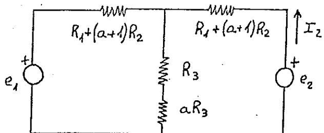
Transformamos en resistencia el generador de tensión central que depende de la corriente que lo atraviesa. Desaparece  $I_1$  que ya no se utiliza para nada.
