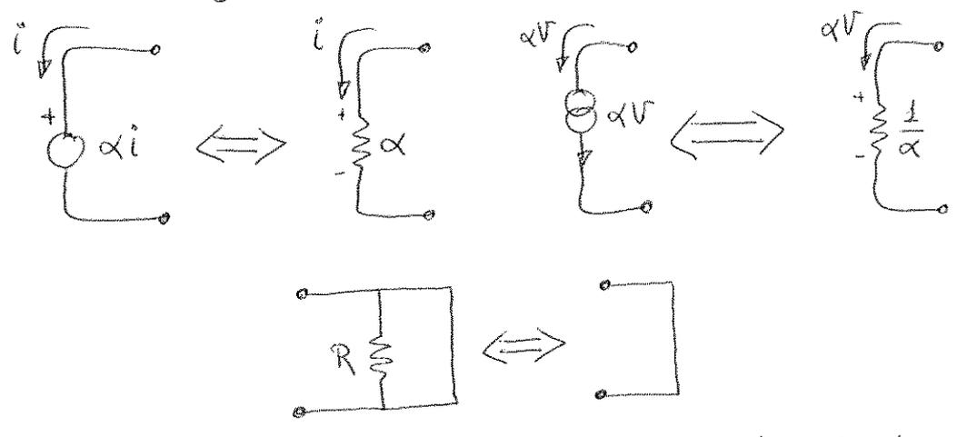
Los generadores de tensión y corriente ideales No se pueden transformar, pues carecen de  $R_g$  ( $R_g=0$  y  $R_g \rightarrow \infty$ )
