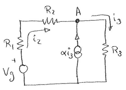
nudo A:  $i_2 + \alpha i_3 = i_3 \Rightarrow i_3 = \frac{i_2}{1-\alpha}$
