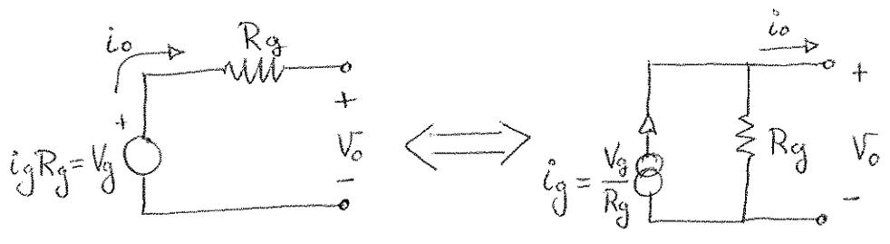
Para que los dos circuitos sean equivalentes, es necesario que tanto  $i_o$  como  $V_o$  sean iguales en ambos circuitos, pues estas variables afectarán al circuito al que se conecte la equivalencia y no podemos cambiarlo.
