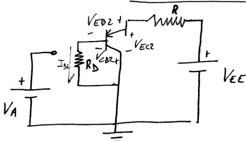
Suponiendo  $T_2 \equiv \text{SAT} \Rightarrow \begin{cases} V_{EB2} = V_{BE} \\ V_{EC2} = V_{ECsat} \end{cases}$
