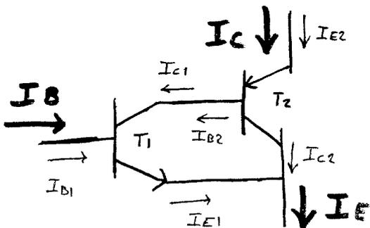
Fijando  $I_B$  como corriente de base del par acoplado,  $I_B$ , y observando que es entrante, sabemos ya que  $I_C$  debe ser también entrante (le adjudicamos  $I_{E2}$ ), e  $I_E$  debe ser saliente (le adjudicamos  $I_{E1} + I_{C2}$ ).
