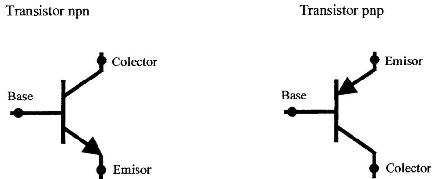
Cada uno de los tres terminales tiene una tensión determinada y circula por él una corriente. Sin embargo las tensiones absolutas de base, emisor o colector ( $V_C, V_E, V_B$ ) no suelen ser de nuestro interés. Lo que normalmente calcularemos son las tensiones relativas entre dos terminales del transistor. En el siguiente esquema se muestran las corrientes y tensiones que, con más frecuencia tendremos que calcular.:
