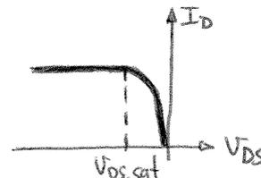
Vemos en el circuito que:  $V_{GG} = V_{GS} = 3\text{ V} > V_T \Rightarrow \text{FET} \equiv \text{Corte}$
