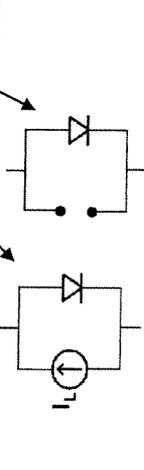
NOTA: El estado del diodo ideal no depende de la existencia de luz.
