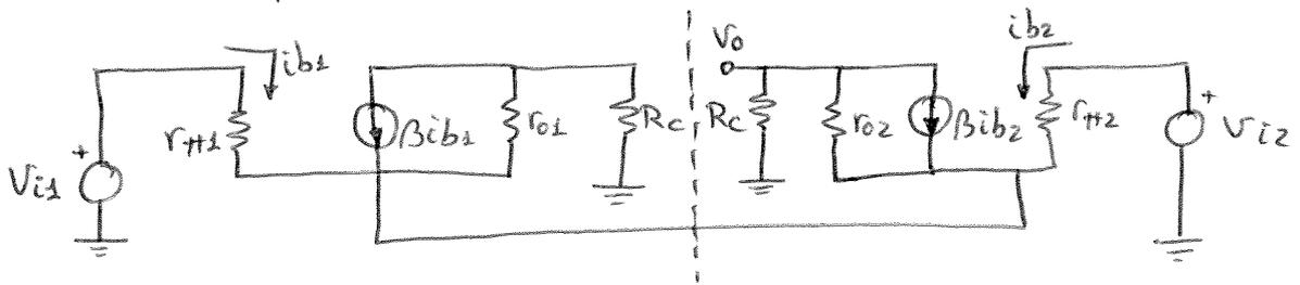
b) modo común :  $A_c = \frac{V_{oc}}{V_{ic}}$
