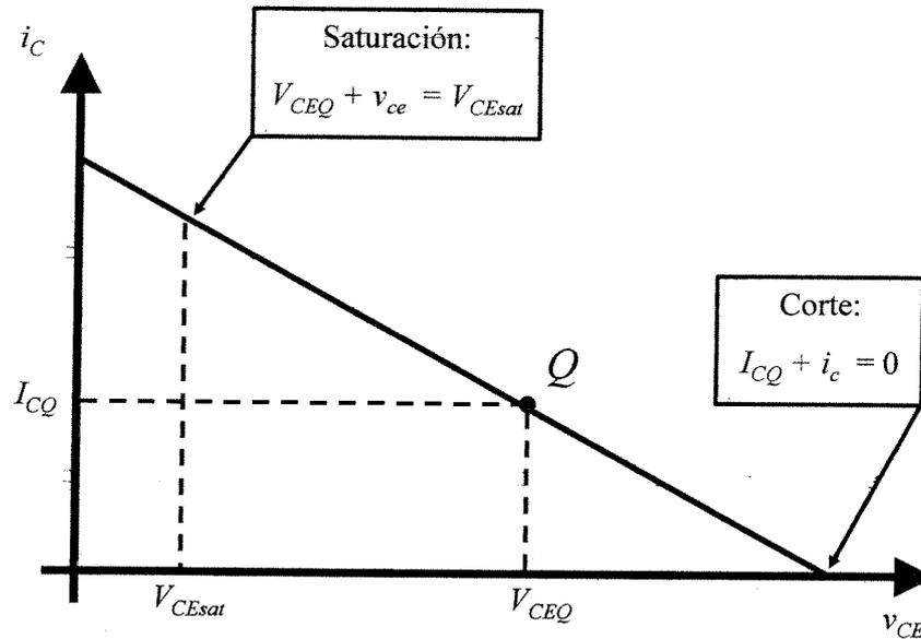
Una vez que tengamos dibujado el circuito equivalente en pequeña señal tenemos que obtener el valor de  $v_0$  para el que el transistor se corta o se satura. Ambas condiciones las estudiaremos siempre por separado:
