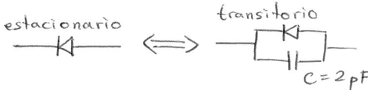
$\left\{ \begin{array}{l} R. \text{ transitorio: hay condensador} \\ V_I = 0 \text{ (cortocircuito a masa)} \\ D \equiv \text{OFF (así empieza el transitorio)} \end{array} \right.$
