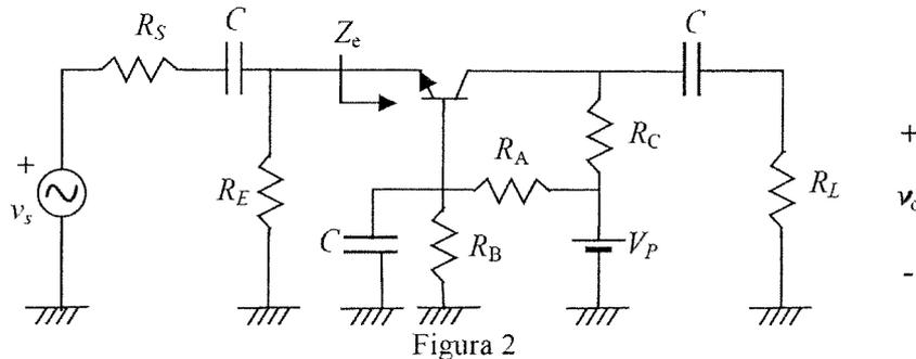
Datos:  $R_s=50 \Omega$ ;  $R_i=1 \text{ k}\Omega$ ;  $R_B=2 \text{ k}\Omega$ ;  $R_E=9,3 \text{ k}\Omega$ ;  $R_C=4 \text{ k}\Omega$ ;  $R_L=750 \Omega$ ;  $V_P=15 \text{ V}$ ;  $V_i=0,025 \text{ V}$ ;  $C \rightarrow \infty$
