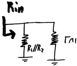
$$R_{in} = R_1 // R_2 // r_{n1}$$
