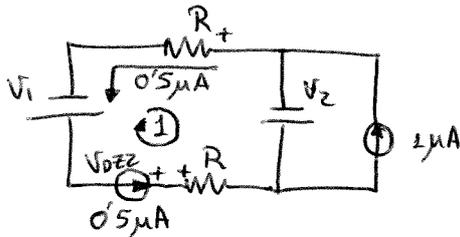
mallá 1:  $V_2 - V_1 + 2 \cdot 0,5 \mu \cdot R - V_{DZ2} = 0$
