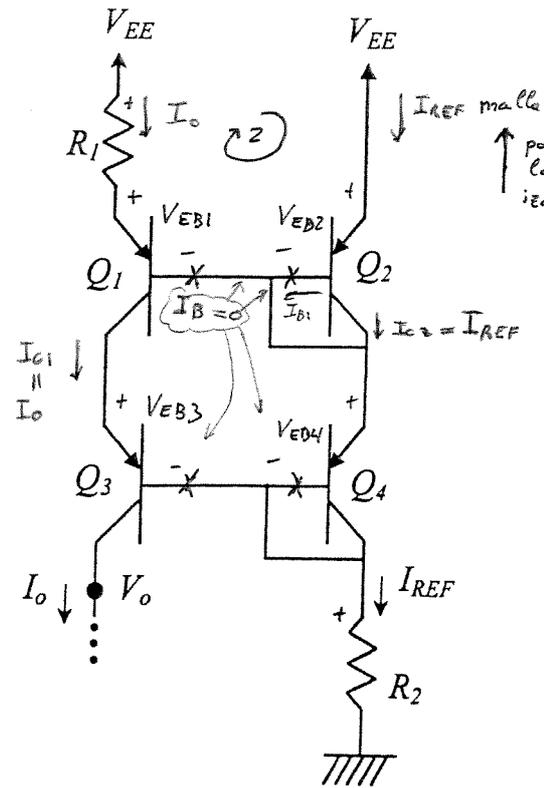
a)  $I_{REF}?$   $V_{EB2} = V_{EB4} = 0,6 \text{ V}$
