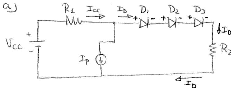
$I_{D1} = I_{D2} = I_{D3} = I_D \Rightarrow$  Sólo tenemos dos posibles combinaciones de estado: o los tres diodos ON o los tres OFF, pues basta con que uno esté OFF para que sea un circuito abierto y no deje conducir a los otros.
