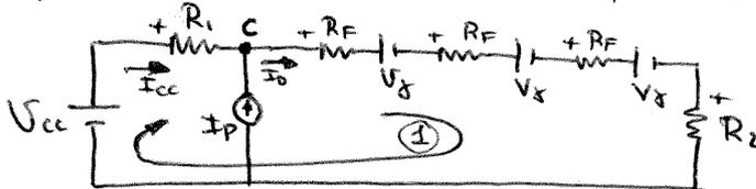
Nudo C:  $I_{cc} + I_P = I_D; \quad I_{cc} = I_D - I_P$
