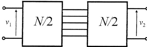
A los dos circuitos resultantes los llamamos **semisecciones** y a los cables que unen las semisecciones las llamamos **ramas de enlace**
