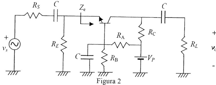
Datos:  $R_s=50 \Omega$ ;  $R_A=1 \text{ k}\Omega$ ;  $R_B=2 \text{ k}\Omega$ ;  $R_E=9,3 \text{ k}\Omega$ ;  $R_C=4 \text{ k}\Omega$ ;  $R_L=750 \Omega$ ;  $V_P=15 \text{ V}$ ;  $V_T=0,025 \text{ V}$ ;  $C \rightarrow \infty$
