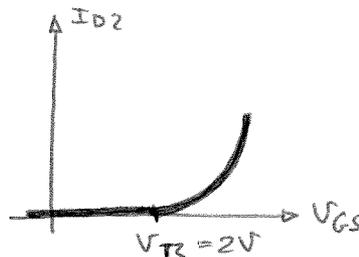
$V_T$  es la tensión tal que si  $V_{GS} < V_T$  el conjunto se corta. Es necesario que los dos FETs se corten para que el conjunto se corte (es decir, si uno conduce, el conjunto conduce, pues  $I_D = I_{D1} + I_{D2}$ ). Así,  $V_T = 1\text{ V}$
