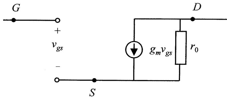
De esta forma estamos modelando el FET como una fuente de corriente controlada por la tensión alterna entre puerta y fuente
