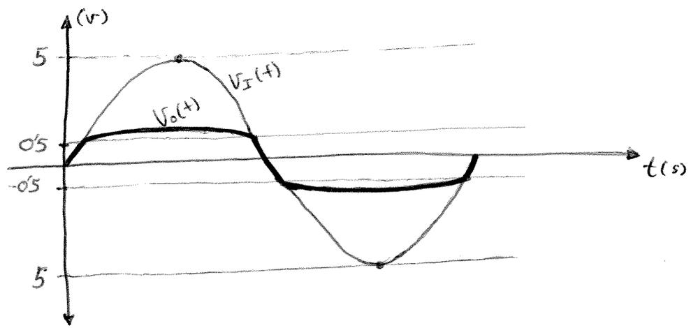
De lo único que nos tenemos que preocupar es de calcular dónde estará el nuevo máximo de  $V_o$ . Para ello, mediante la función de transferencia calculamos en qué se transforma  $V_I = 5V$ . Obtenemos  $V_o = 0'5445$ .
