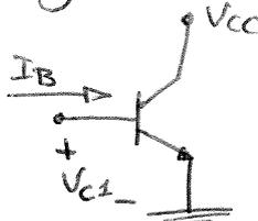
$I_B = 0$  (abierto)  $\Rightarrow$   $BJT \equiv \text{corte} \Rightarrow v_{C1} = 0$
