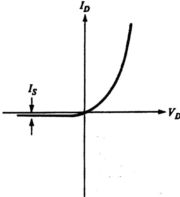
En la siguiente figura se muestra una curva característica real de un diodo de silicio IN 4135 a 25°C donde la tensión está medida en voltios (V) y la corriente en miliamperios (mA).
