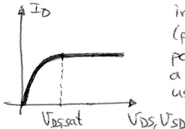
*Nota:* en este ejercicio nos invierten el sentido de  $V_{GS2}$  (ponen  $V_{SG}$ ), del Most de canal p, por lo que entonces NO vamos a invertir las gráficas, usaremos las mismas que para un canal n.
