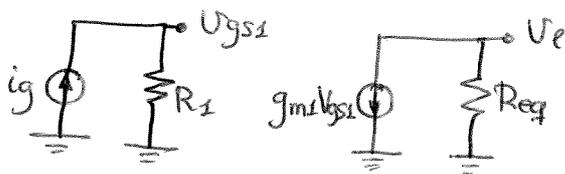
$$V_L = -g_{m1} V_{gs1} \cdot R_{eq}$$
