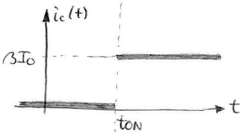
$i_{c2}(t)$  es la corriente a través del condensador. Sólo existe esta corriente en el régimen transitorio (cuando hay condensador). Hemos visto en este apartado que, en  $0 < t < t_{ON}$  tenemos  $i_{c2}(t) = I_0$
