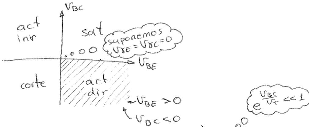
$$* I_E = I_{ES} \left( e^{\frac{V_{BE}}{V_T}} - 1 \right) - \alpha_R I_{CS} \left( e^{\frac{V_{BC}}{V_T}} - 1 \right) =$$
