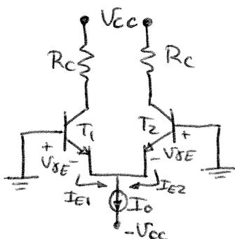
por simetria:  $I_{E1} = I_{E2} = \frac{I_0}{2} = (\beta + 1) I_B$
