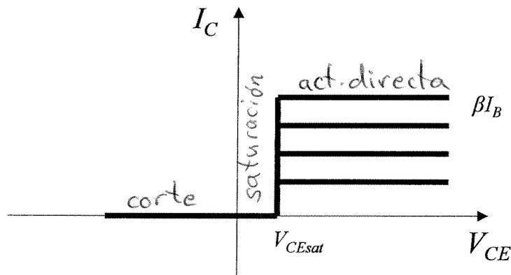
Para el transistor npn el eje de abscisas es  $V_{CE}$
