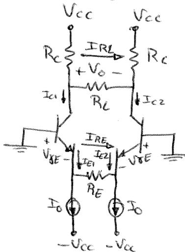
mallá:  $-V_{BE} - I_{RE} \cdot R_E + V_{BE} = 0$
