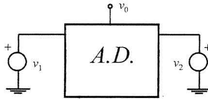
Donde la salida viene dada por:  $v_0 = A_d(v_1 - v_2) + A_c\left(\frac{v_1 + v_2}{2}\right) = A_d v_d + A_c v_c$
