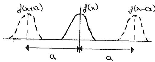
Consideramos la función  $f(x)$ . Si reemplazamos  $x$  por  $x-a$  obtenemos la función  $f(x-a)$ . Evidentemente la curva no ha cambiado. Suponiendo que  $a$  es positiva, vemos que la curva ha sido desplazada hacia la derecha, análogamente tenemos que  $f(x+a)$  corresponde a un desplazamiento hacia la izquierda.
