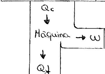
El calor que entra  $Q_c$ , procede de un foco caliente a temperatura  $T_c$ ; el calor que se escapa  $Q_f$ , se cede a un foco térmico a una temperatura inferior  $T_f$ .
