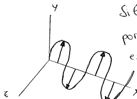
Si los desplazamientos son paralelos, por ejemplo, al eje  $y$ , la cuerda estará siempre en el plano  $XY$ , y decimos que el movimiento ondulatorio está polarizado linealmente
