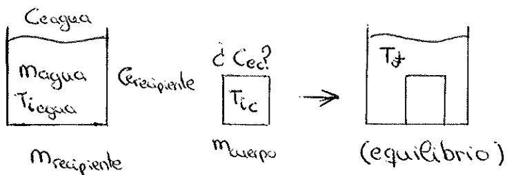
$$Q_{\text{cedido por el cuerpo}} = m_c \cdot C_c (T_{ic} - T_f)$$
