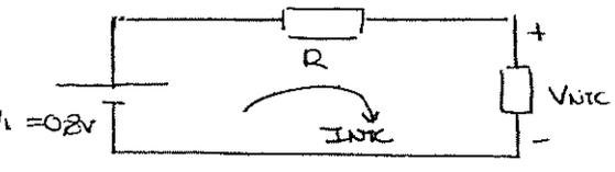
Todo circuito se puede poner como una pila y una resistencia (eg. Thevenin)
