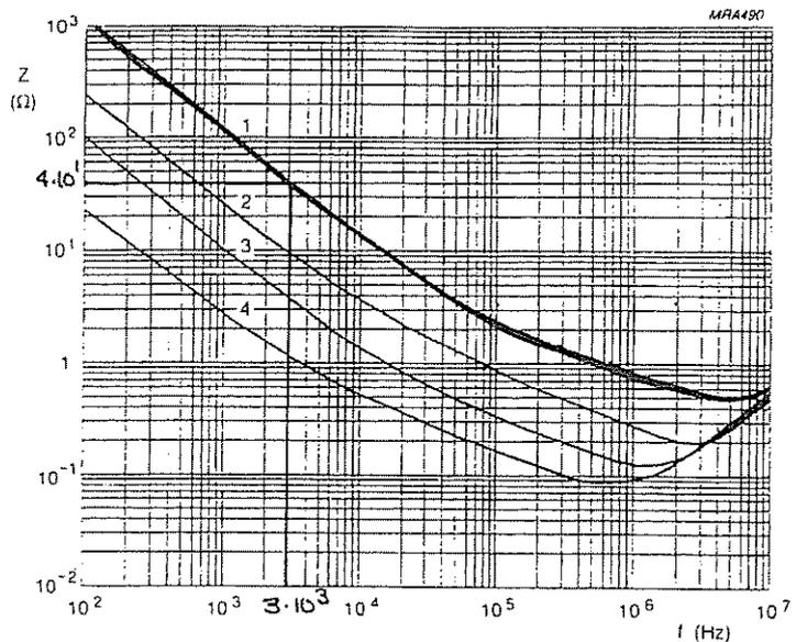
Módulo de la impedancia de condensador en función de la frecuencia. (CURVA 1)
