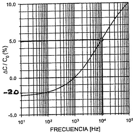
Figura 1. Capacidad del condensador en función de la frecuencia a temperatura nominal.
