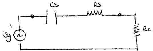
circuito equivalente en alterna.
