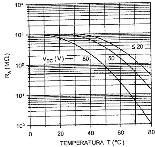
Figura 2. Resistencia de aislamiento en función de la temperatura ambiente y de la tensión aplicada.
