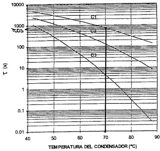
Figura 3. Constante de tiempo de autodescarga de los tres condensadores disponibles (C<sub>1</sub>, C<sub>2</sub> y C<sub>3</sub>) en función de la temperatura del cuerpo del condensador.
