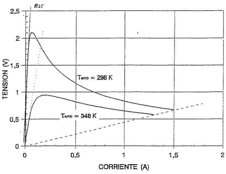
Característica I-V en escala lineal de un NTC para dos temperaturas ambientes distintas.
