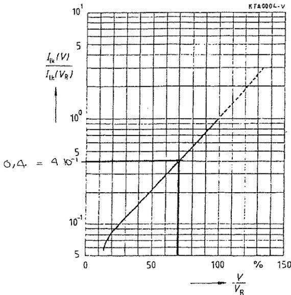
Factor multiplicador de la corriente de fugas en función de la tensión aplicada (relativa a la tensión nominal).
