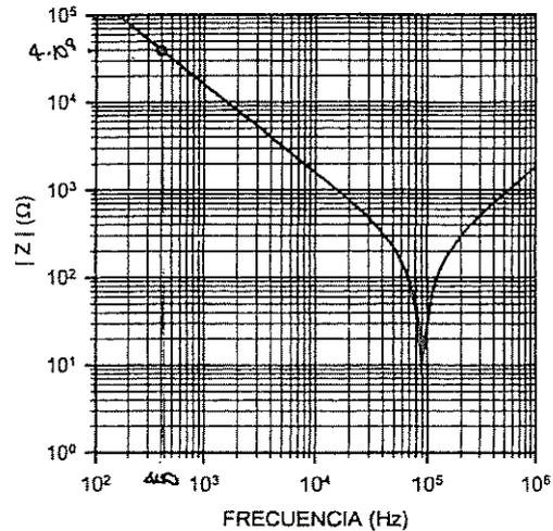
Módulo de la impedancia del condensador en función de la frecuencia.
