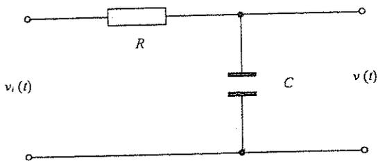
Figura 1. Esquema del circuito del que forma parte el condensador.
