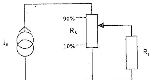
Figura 1. Montaje potenciométrico
