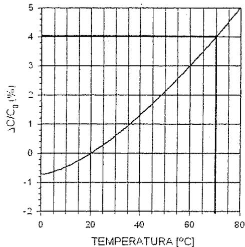
Figura 2. Variación relativa de la capacidad con la temperatura del cuerpo del condensador. Curvas válidas para los tres condensadores disponibles.
