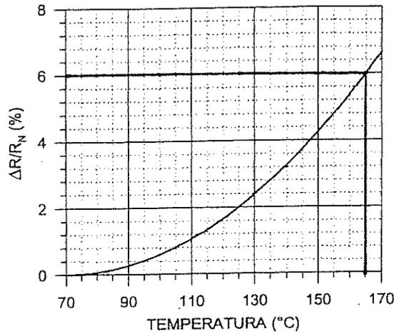
Figura 2. Variación relativa de la resistencia en función de la temperatura del cuerpo del resistor.
