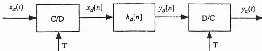
donde el primer bloque conversor continuo-discreto (C/D) muestrea de forma ideal la señal de entrada cada  $T$  segundos obteniéndose  $x_d[n]=x_a(nT)$ ; el segundo bloque es un sistema discreto de respuesta al impulso  $h_d[n]$ ; y el tercer bloque es un conversor de discreto a continuo (D/C) mediante una operación de interpolación, descrita por la siguiente expresión:
