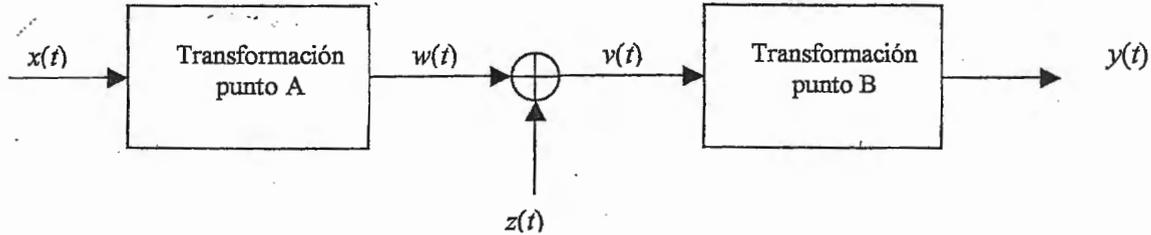
donde los bloques 'Transformación punto A y punto B' representan una o varias transformaciones en cascada exclusivamente del tipo escalado-temporal o filtro paso bajo ideal. De las señales involucradas en el proceso únicamente se sabe que son reales y de banda limitada ( $x(t)$  es paso bajo y  $z(t)$  es paso banda) verificando,
