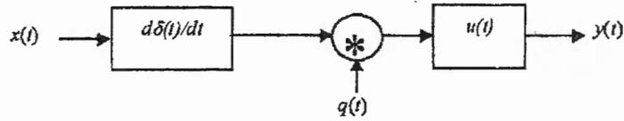
Donde las señales en los recuadros representan la respuesta impulsiva de dos filtros lineales e invariantes y el asterisco representa la operación de convolución.  $x(t)$  e  $y(t)$  representan respectivamente la entrada y la salida del sistema.  $x(t)$  es una señal de media nula.
