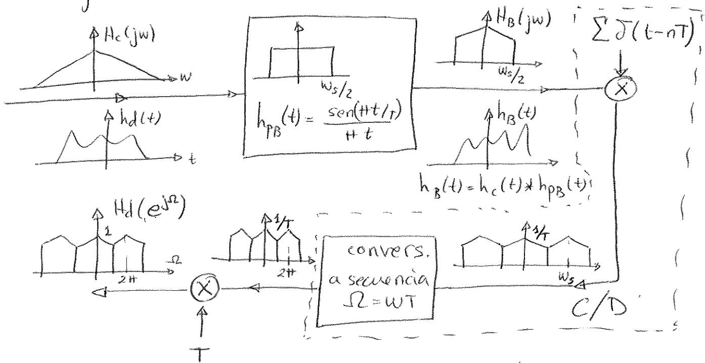
$$H_d(e^{j\omega}) = H_c(j\frac{\omega}{T}), \quad |\omega| < T \quad (\text{periódica } 2T) ; \quad h_d[n] = T h_B(nT)$$
