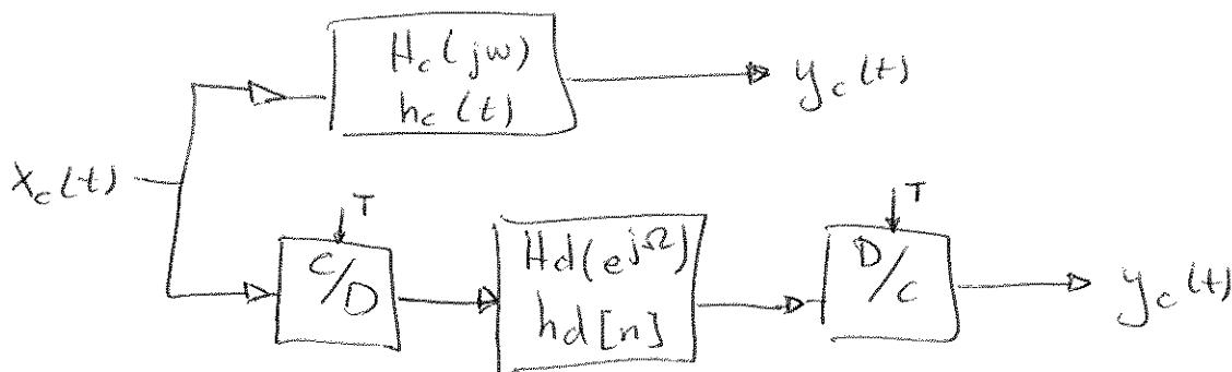
$$H_c(j\omega) \rightarrow H_d(e^{j\omega}) = \begin{cases} H_c(j\frac{\omega}{T}), & |2| < \pi \\ \text{periódica } 2\pi & \end{cases} = \begin{cases} 1 + \alpha e^{-j\frac{2\pi t_0}{T}}, & 1 \leq k \leq H \\ & \text{periódica } 2\pi \end{cases}$$
