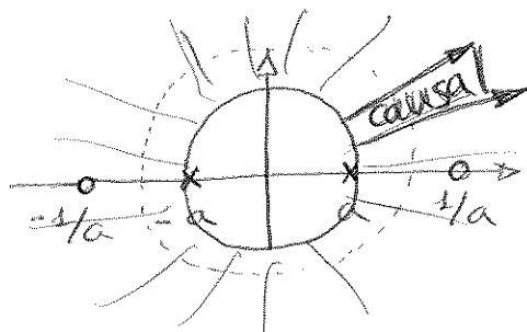
$$|H(e^{j\omega})|^2 = H(e^{j\omega}) \cdot H^*(e^{j\omega}) = \frac{(e^{-j2\omega} - a^2)}{(1 - a^2 e^{-j2\omega})} \cdot \frac{(e^{j2\omega} - a^2)}{(1 - a^2 e^{j2\omega})} =$$
