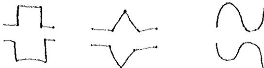
Con receptor óptimo siempre se necesitan 3 dB menos de SNR para una misma BER si se usan señales antipodales en lugar de ortogonales.
