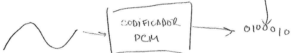
Como ejemplo de parámetros de sistemas reales, el *Compact Disk* utiliza una  $f_s = 44$  KHz y cuantifica cada muestra con  $n = 16$  bits, lo que permite tener  $L = 2^n = 2^{16}$  niveles de cuantificación.
