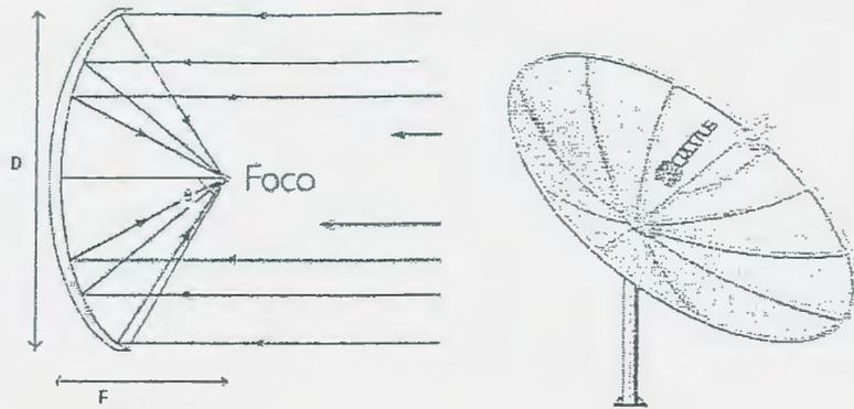
F se define como la distancia focal y D como el diámetro del paraboloide. La relación F/D define a la antena, y es importante para definir de qué manera ilumina el alimentador a la superficie del reflector. Se obtiene a partir de las ecuaciones de la parábola. La expresión que más utilizaremos es:
