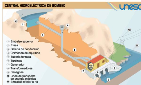
Figura 5: Esquema de una central de bombeo
